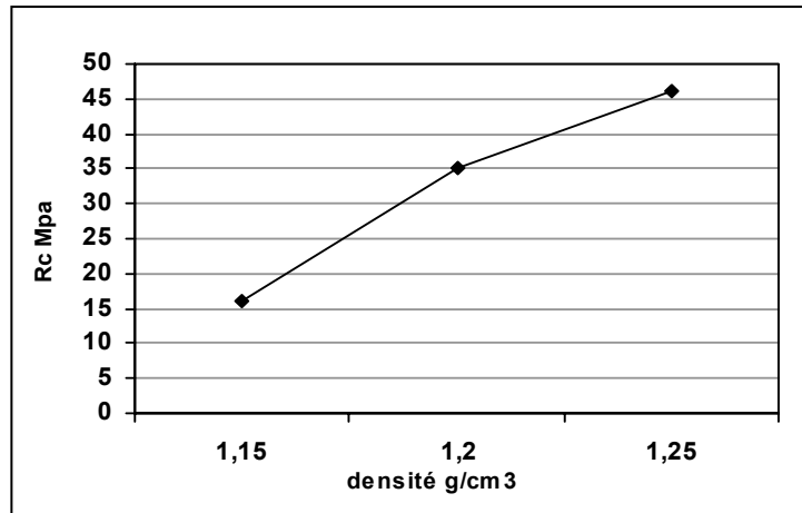
Figure 5.20 : L'influence de la densité de l'activant et l'étuvage sur la résistance en Compression après 1 jour d'étuvage.
