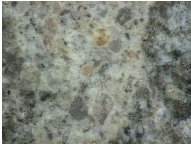
Figure 6.59 : L'interface mortier – granulat d'un béton à portland au laitier cristallisé (BOGL).
