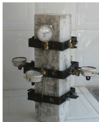
Figure 6.32 : l'emplacement des cadres et cadrans sur l'éprouvette.
