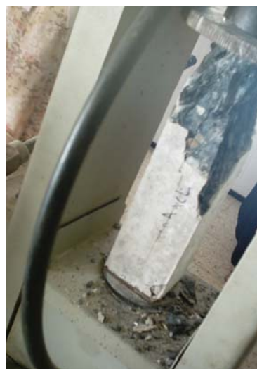
Figure 6.34 : éprouvette brisée par Compression.
