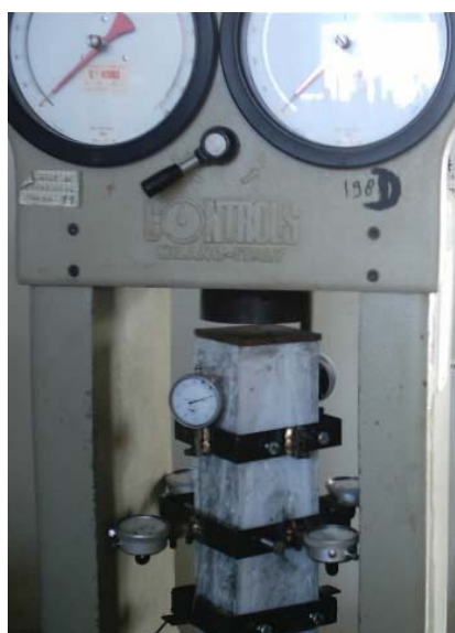
Figure 6.33 : Les déformations mesurées pendant La compression .
