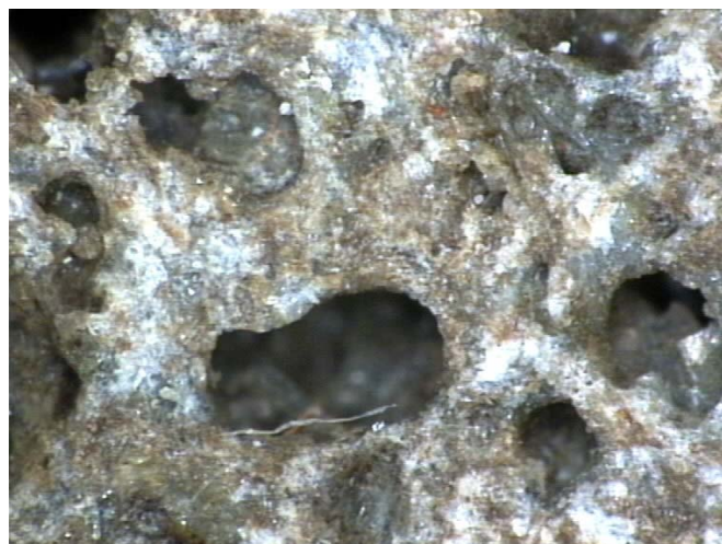
Figure 6.63 : Un grain du laitier cristallisé dans un béton basique.
