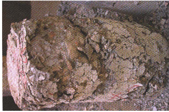
Figure 6.56 : Etat d'un béton chauffé (900°C) à base d'un liant à la fumée de silice. (Jaknoun, 2005).
