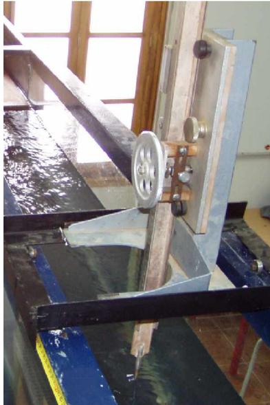
Photographie 3.10 : Vue de profil du limnimètre à vernier utilisé.
