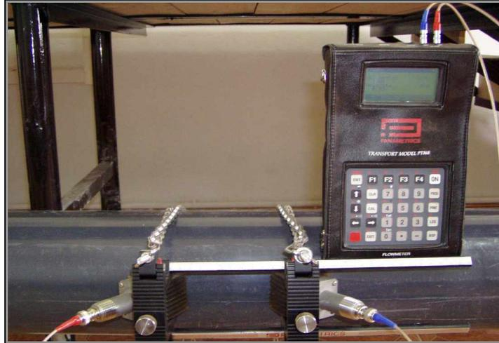
Photographie 3.11 : Vue du débitmètre à ultrasons inséré dans la conduite d'alimentation du canal de mesures.
