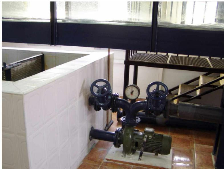
Photographie 3.3 : Vue de la pompe axiale utilisée insérée dans la conduite circulaire à l'aval du bassin d'alimentation et de récupération des eaux
