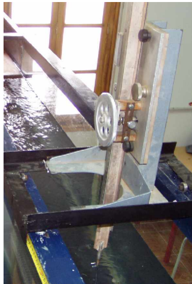
Photographie 12: Vue de profil du limnimètre à vernier utilisé.
