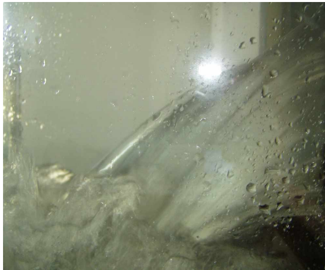
Photographie 8 : Vue de travers de la lame liquide déversante, montrant clairement la contraction latérale de l'écoulement.
