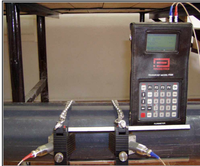
Photographie 13 : Vue du débitmètre à ultrasons inséré dans la conduite d'alimentation du canal de mesures.
