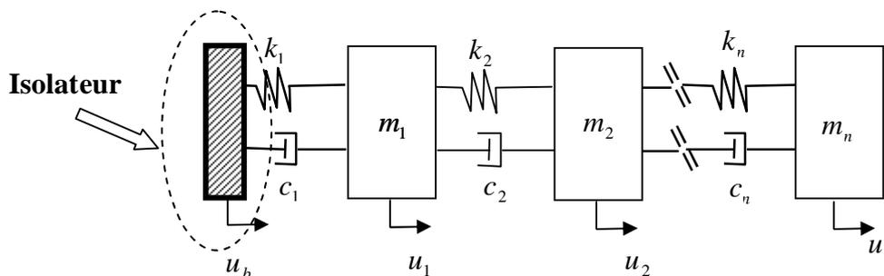
**Fig.3.1** : Modèle physique d'une structure avec isolateur parasismique
