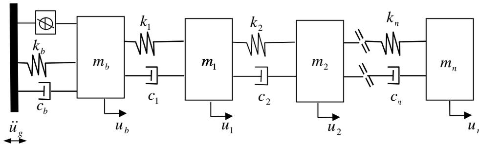
**Fig. 3.3** : modèle mathématique d'une structure avec isolateur en LRB à n DDL
