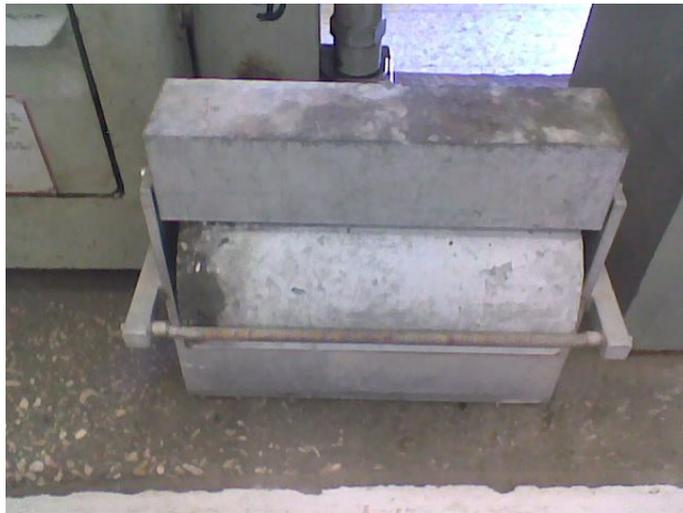
*Photo 4-3 : Eprouvettes cylindriques (16x32) cm<sup>2</sup>.*
