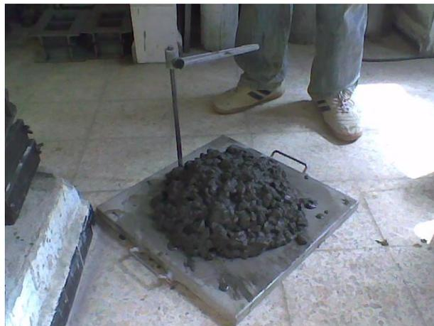
*Photo 4-1 : Essai du Slump-test.*
