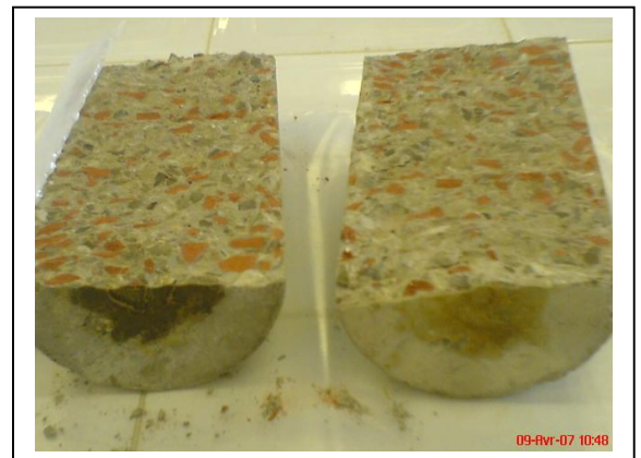
Photo 5-2 : rupture des éprouvettes « l'essai brésilien ».
