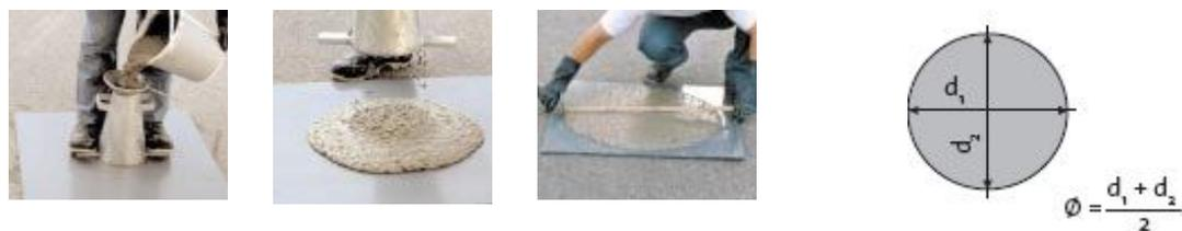
Phot. 2.3 - Détermination de l'étalement. [24]
