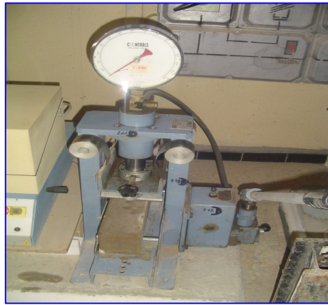
Phot. 3.12- Dispositif pour mesurer la résistance à la traction par flexion.
