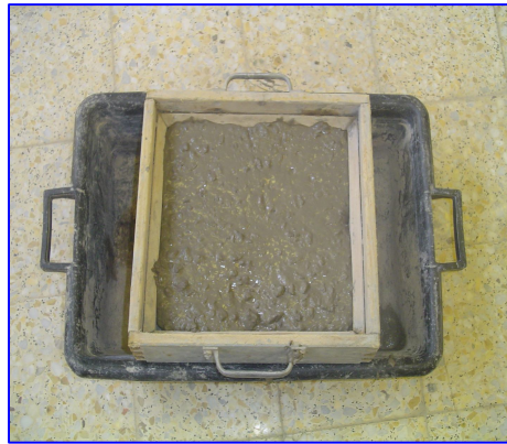
Phot. 3.10- Essai de stabilité au tamis. [40]
