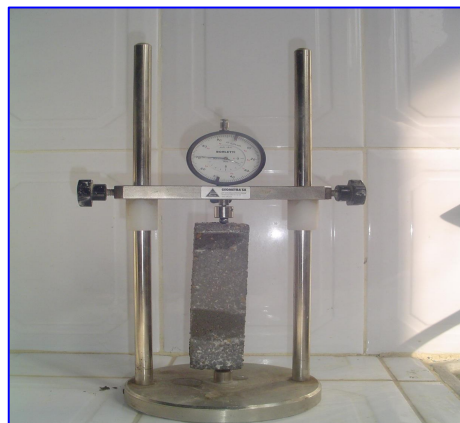
Phot. 3.14- Dispositif pour mesurer le retrait.
