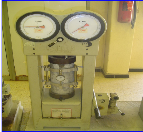
Phot. 3.13- Dispositif pour mesurer le module élastique.
