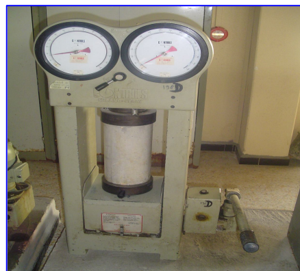
Phot. 3.11- Dispositif pour mesurer la résistance à la compression.
