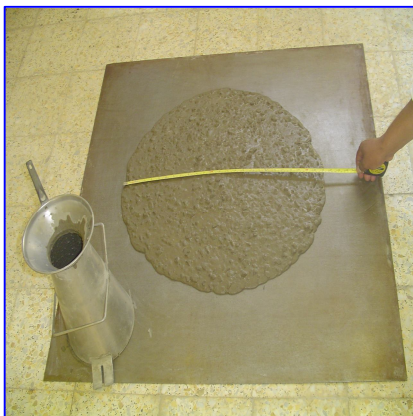
Phot. 3.8- Essai d'étalement [40]
