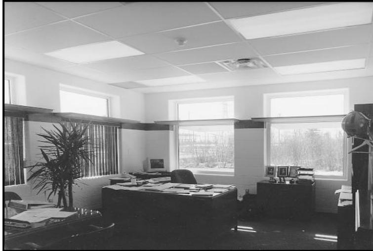
Figure 122 : Façade équipée d'un light shelf et d'un dispositif d'ombrage intérieur.
