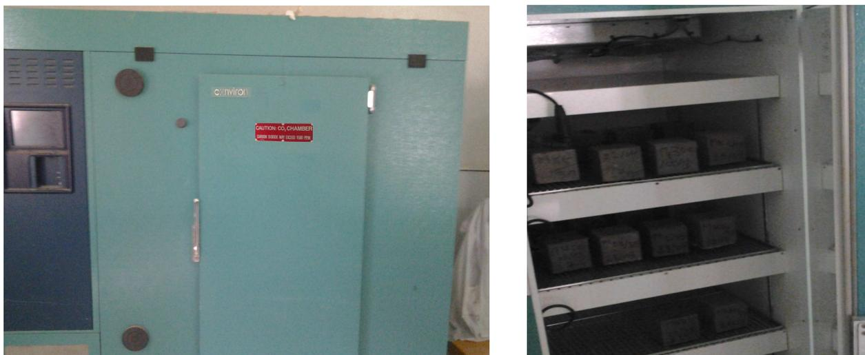
Figure 3.9: Enceinte hermétique (chambre de CO<sub>2</sub>).
