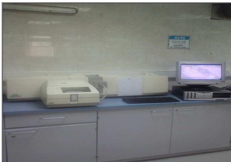
**Figure 3.1:** Granulomètre a laser de type mastersizer (Laboratoire de lafarge M'sila).
