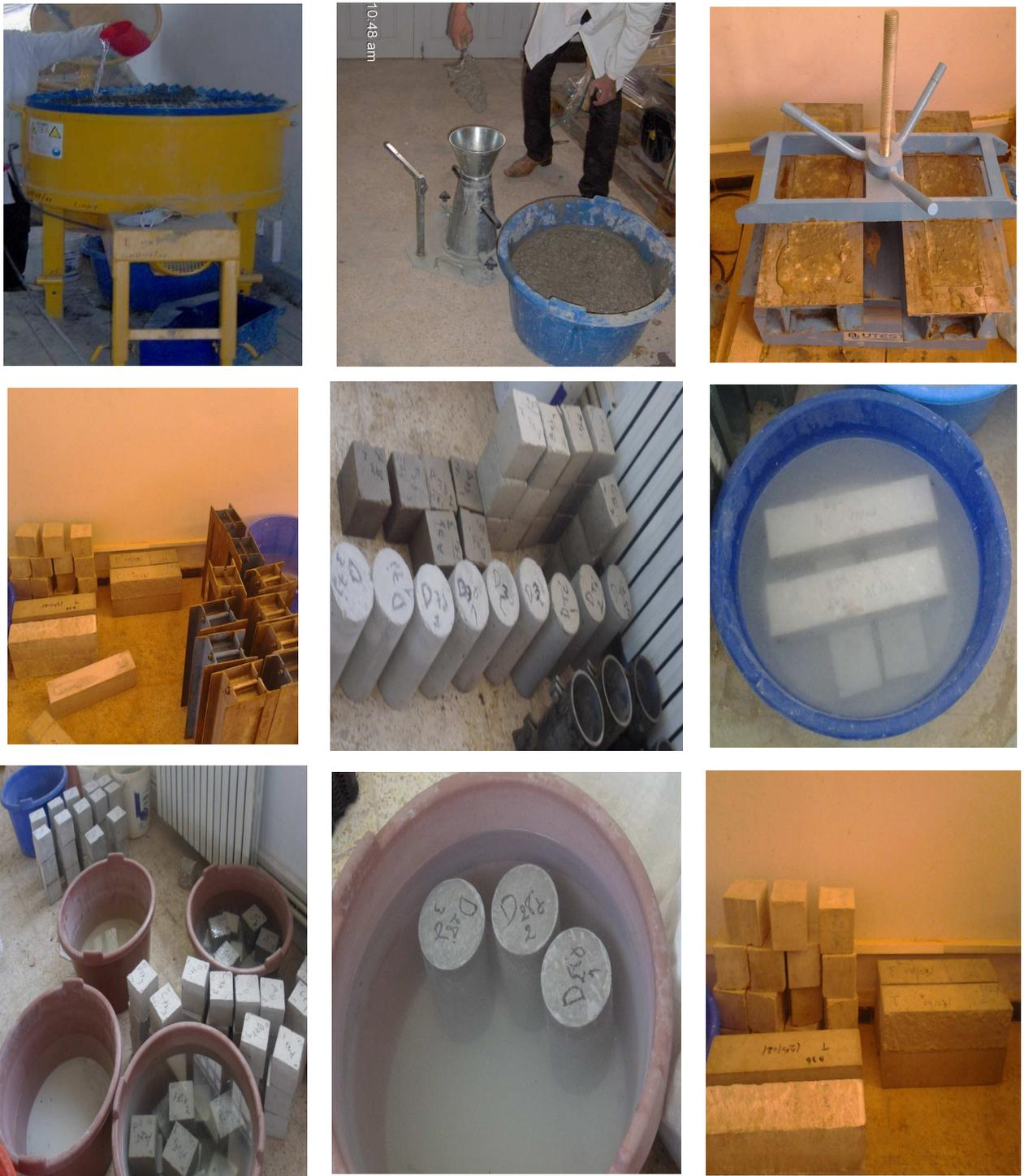
**Figure 3.4:**Etapes de formulation des bétons et conservation des éprouvettes de bétons
