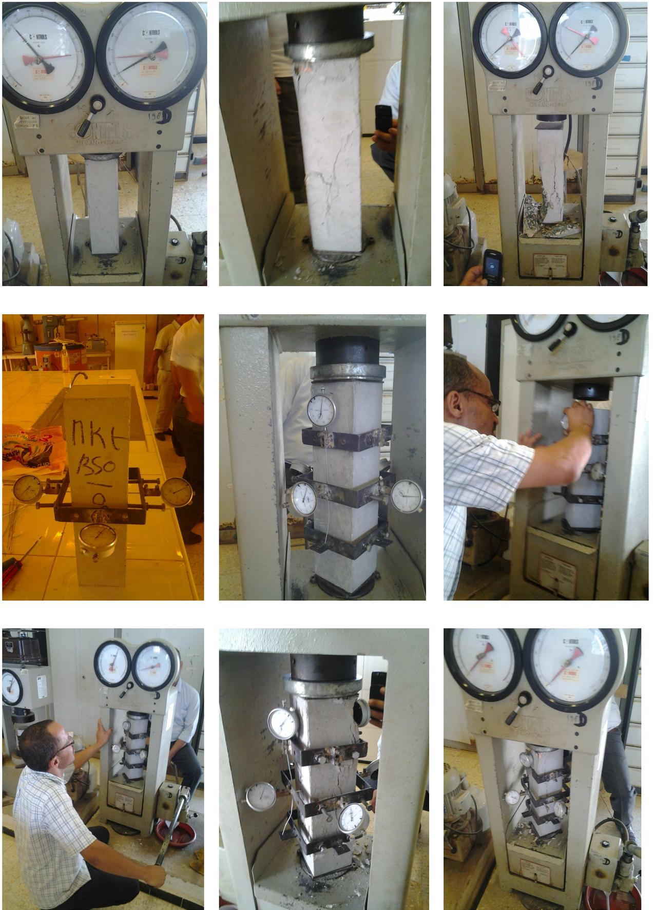
Figure 3.7: Etapes d'essai de déformabilité du béton.
