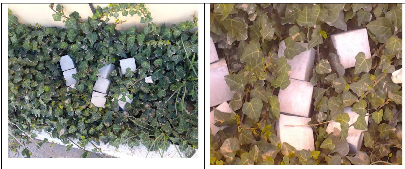
**Figure 3.11:** Photo des éprouvettes conservées en extérieur entre les brindilles de plantes vertes pendant 180 jours et 365 jours.
