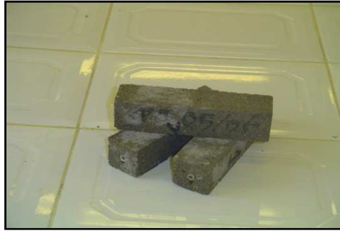
Figure 3.20 : éprouvettes de mortier ( 7 \times 7 \times 28 ) \text{cm}^3 munis de plots mises dans l'enceinte d'étuvage à 28 jours
