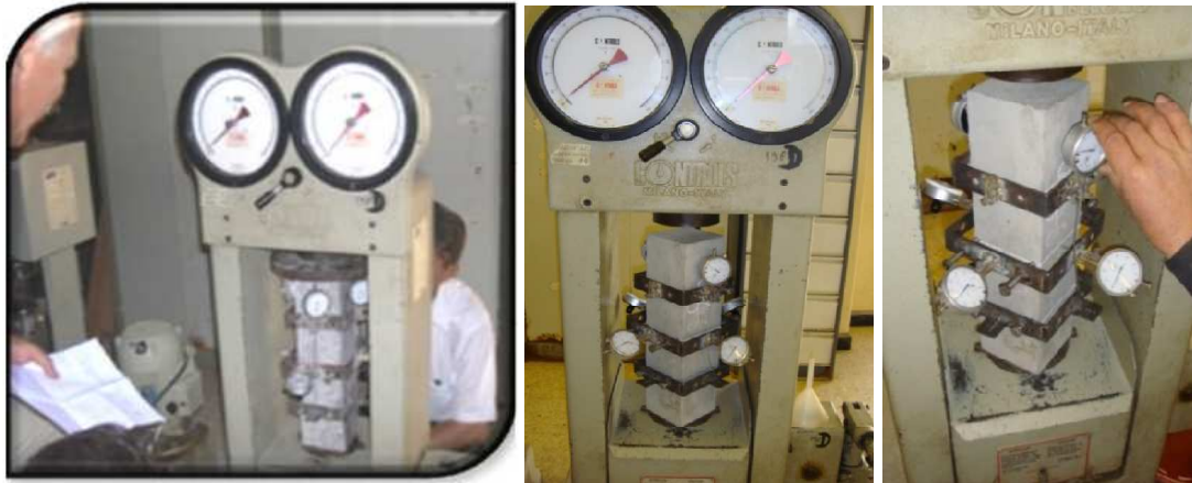
Figure 4.1 : Etapes d'essai de déformabilité du béton.
