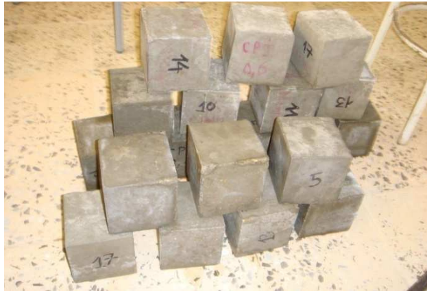
Figure 4.11 : Eprouvettes de bétons de différents types de conservation destinées à l'essai de la porosité par pesées hydrostatique
