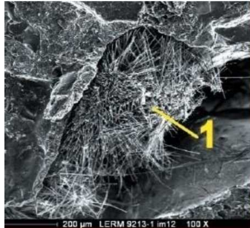
Figure 2.12 : Photo au MEB d'une ettringite secondaire ayant de la place pour se développer dans un pore [NEVILLE 2004].
