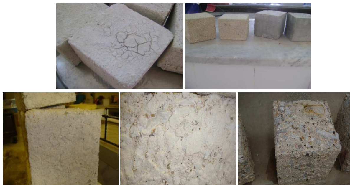
Figure 4.21 : Béton B50 après 21 jours d'immersion dans la solution d'acide
