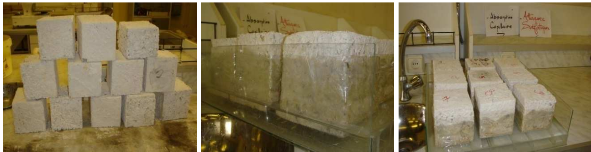
Figure 4.23 : différents bétons attaqués par les acides subits l'absorption capillaire et d'E/C
