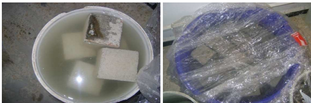
Figure 4.19 : Eprouvettes cubiques 10×10×10 mm 3 immergées dans la solution d'acide
