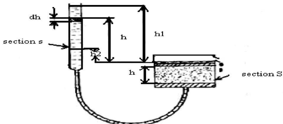
**Figure I .3 :** Perméamètre à charge variable
