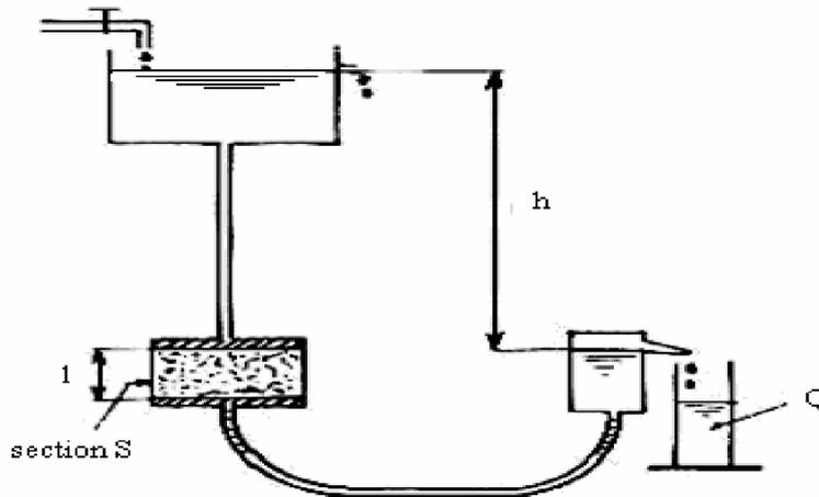
**Figure I.2 :** Perméamètre à charge constante
