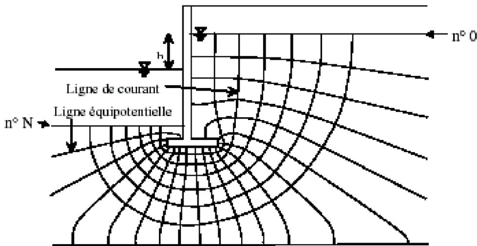
**Figure I.8 :** Exemple de réseau d'écoulement
