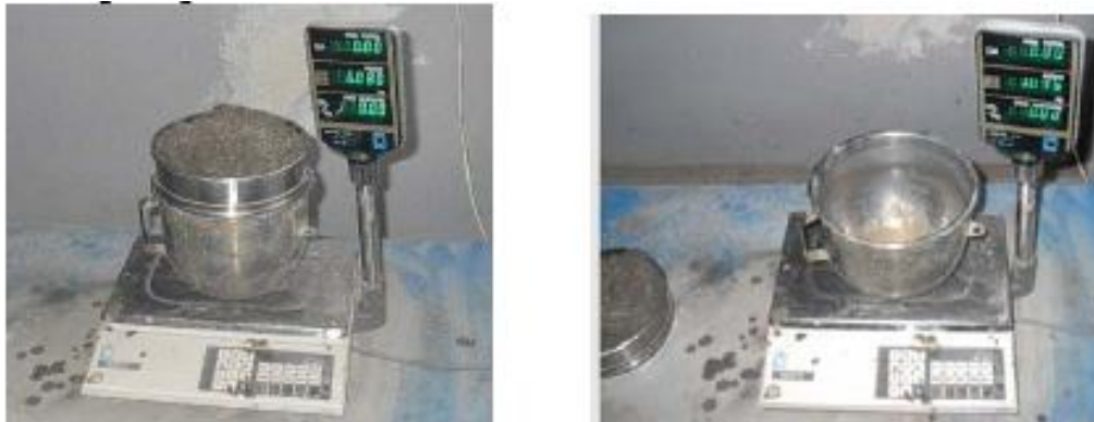
Photo2. 3 - Représentation de l'essai de stabilité au tamis
