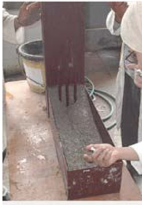
Photo2. 2. - Représentation de l'essai à la boîte en L
