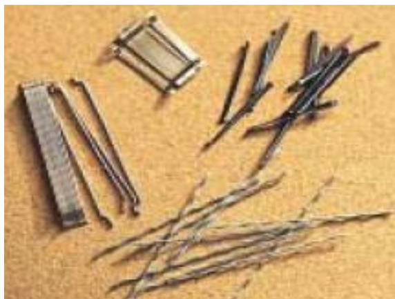
Photo 4.4. Fibres métalliques utilisées dans notre étude
