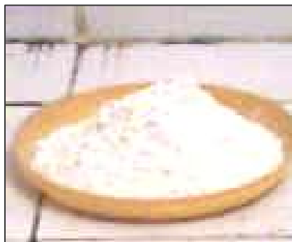
Photo. 4.2- Fillers calcaires utilisés dans notre étude.
