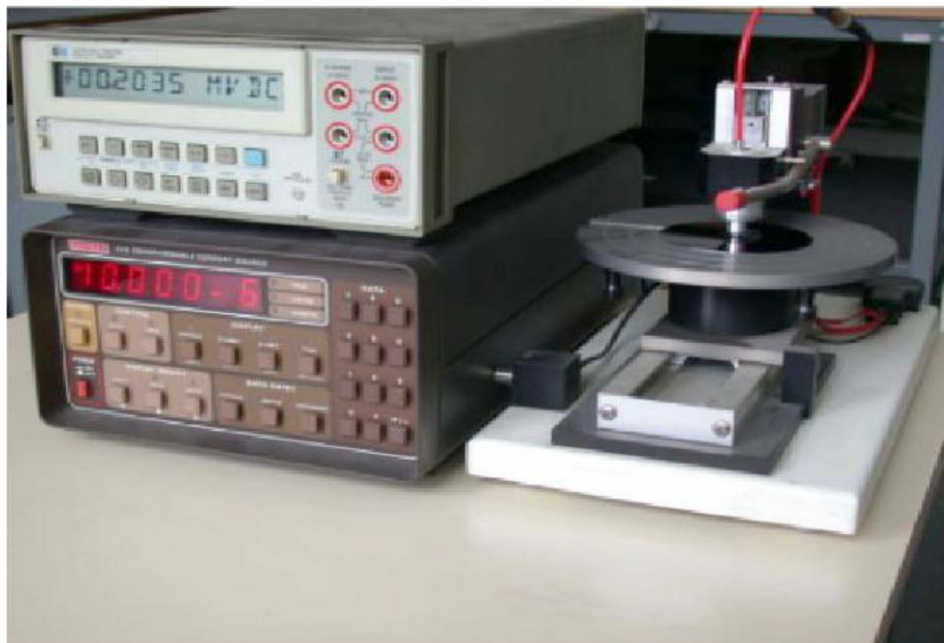
Figure II.14.a) Méthode de quatre pointes.
