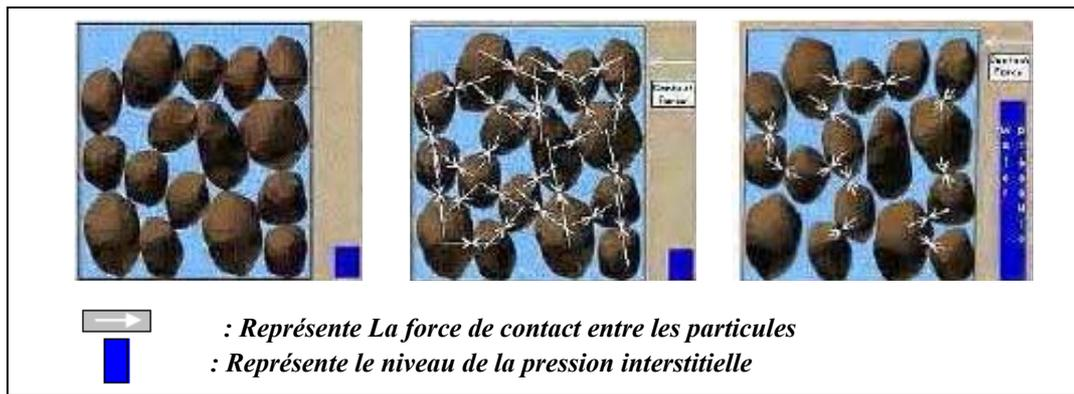
Figure 2.7 : Phénomène de la liquéfaction à l'échelle microscopique
