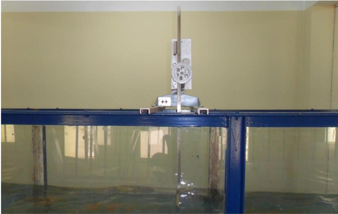
*Figure 1.6: Photographie du déversoir rectangulaire sans hauteur de pelle avec contraction latérale ayant servi à la mesure du débit*
