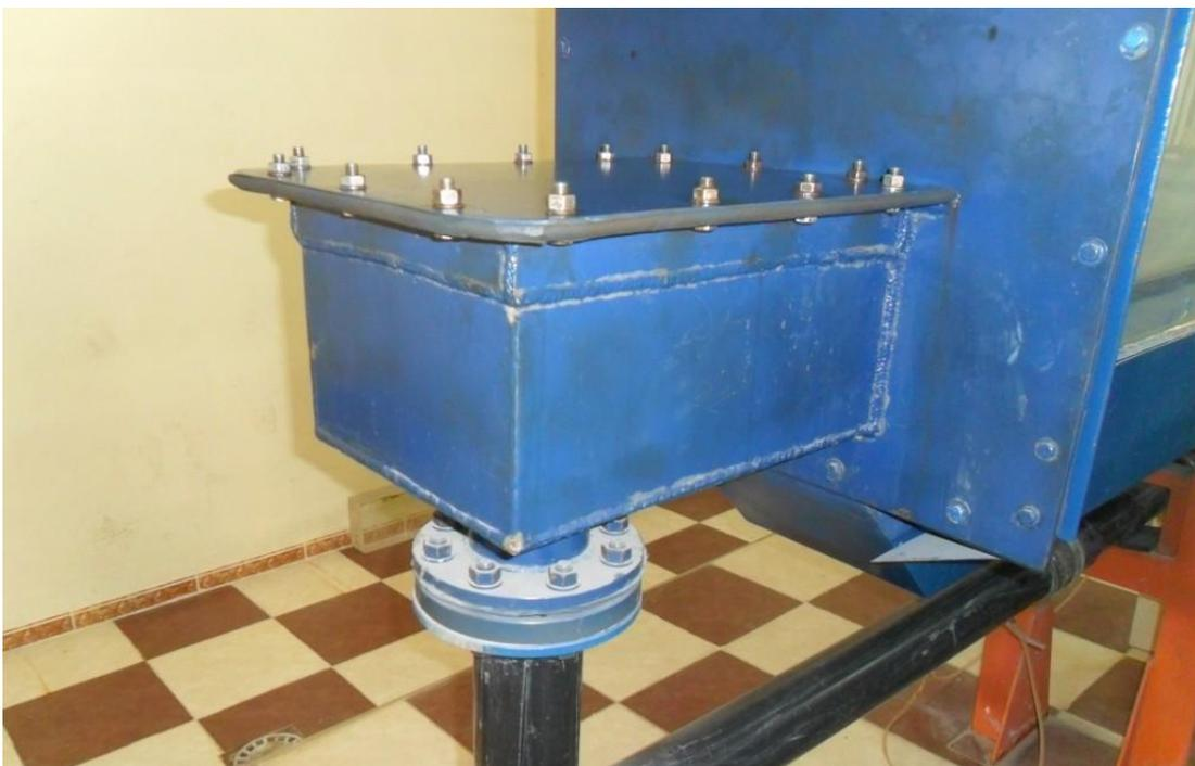
*Figure 1.7 : Photographie d'une boîte en charge*
