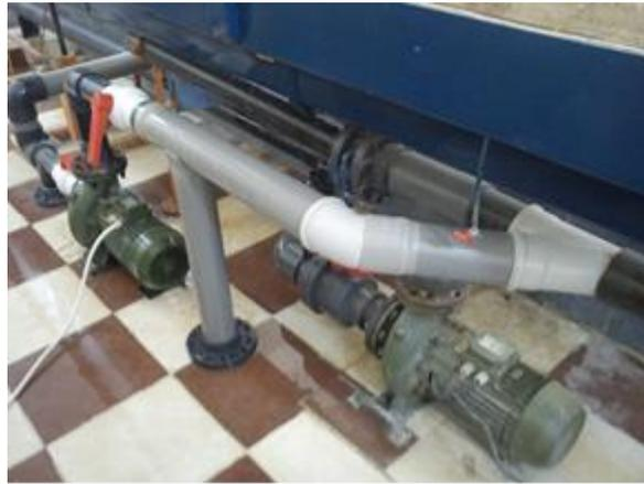
Photo 5.5 : Photographie des Pompes centrifuges (en disposées parallèles).
