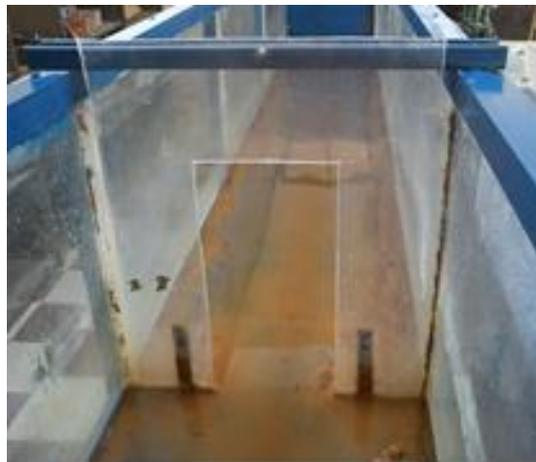
Photo 5.6: Photographie du déversoir rectangulaire sans hauteur de pelle avec contraction latérale ayant servi à la mesure directe du débit.
