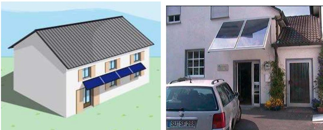
Fig. (I-III-21)- exemple d'installation des capteurs solaires en auvent d'une entrée ou brise soleil.
