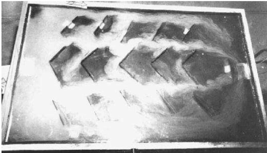
**Fig. (I-II-18)-** Visualisation de l'écoulement d'un jet de fumée dans un capteur en présence de chicanes triangulaires (source : cours de M. MOUMI Abdelhafid, énergétique 1<sup>ère</sup> année magister, 2007-2008)
