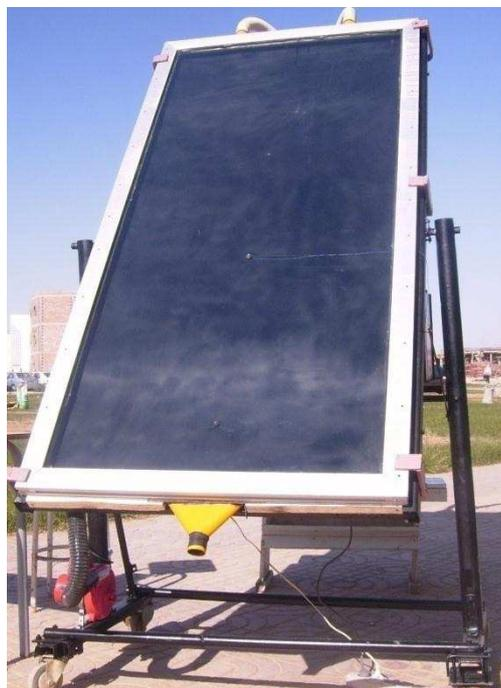
Photo. (I-II-1)- Capteur solaire plan à air exposé au soleil (dgm.Univ de Biskra) (source : cours de M. MOUMI Abdelhafid, énergétique 1<sup>ère</sup> année magister, 2007-2008)
