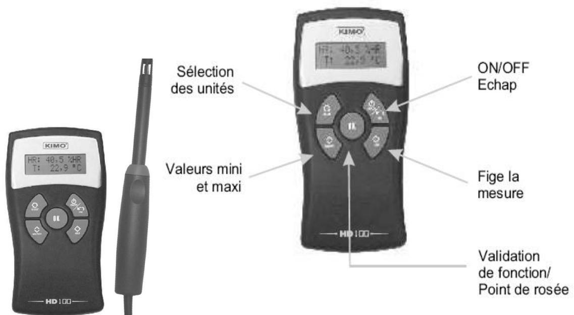
Figure 8.1 Le thermo-hygromètre Kimo, modèle HD100.
