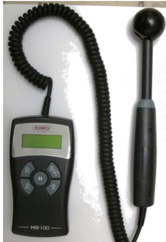
Figure 8.2 Le thermo-anémomètre avec enceinte noirci, Kimo, modèle HD100.
