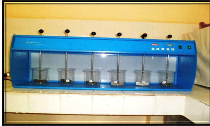
Figure 9: Flocculateur de laboratoire utilisé pour les essais de coagulation-floculation
