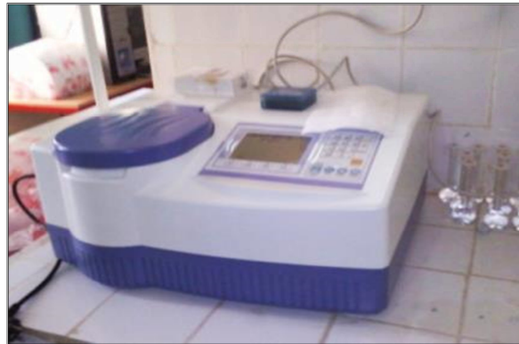
Figure 7: Spectrophotomètre utilisé pour le dosage du zinc par colorimétrie
