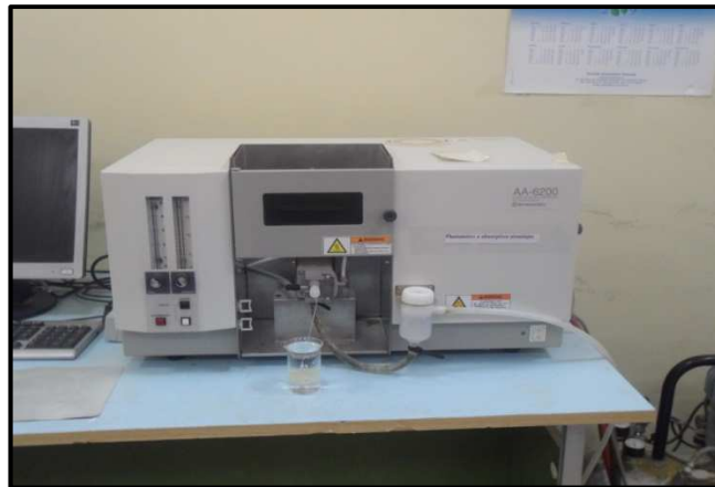
Figure 4 : Spectrophotomètre à absorption atomique utilisé pour le dosage du zinc dans l'eau.
