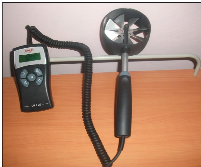
Figure, V.16 : Instrument de mesure « Thermo-Anémomètre à hélice LV 110 ». Source : L'auteur.
