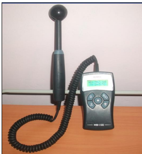
Figure, V.19 : Instrument de mesure « Thermo-hygromètre HD100 ». Source : L'auteur.
