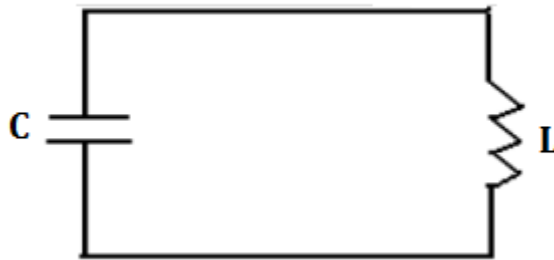
Figure II.16 : Circuit équivalent idéal d'un résonateur [30].
