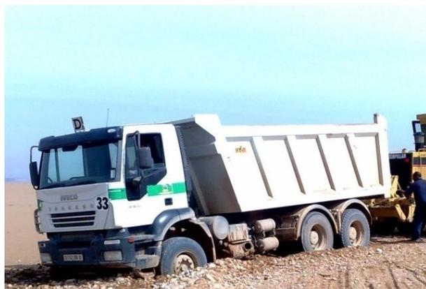
**Figure 4.7** Illustration de la perte de la portance du sol de seabkha à l'état submergé
