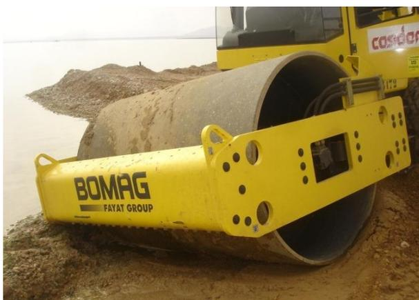
**Figure 4.17** Difficulté de compactage des rives du remblai
