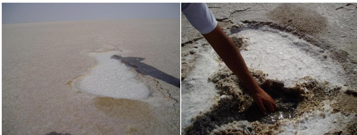
**Figure 4.4** Illustration de la consistance liquide des zones faibles rencontrées
