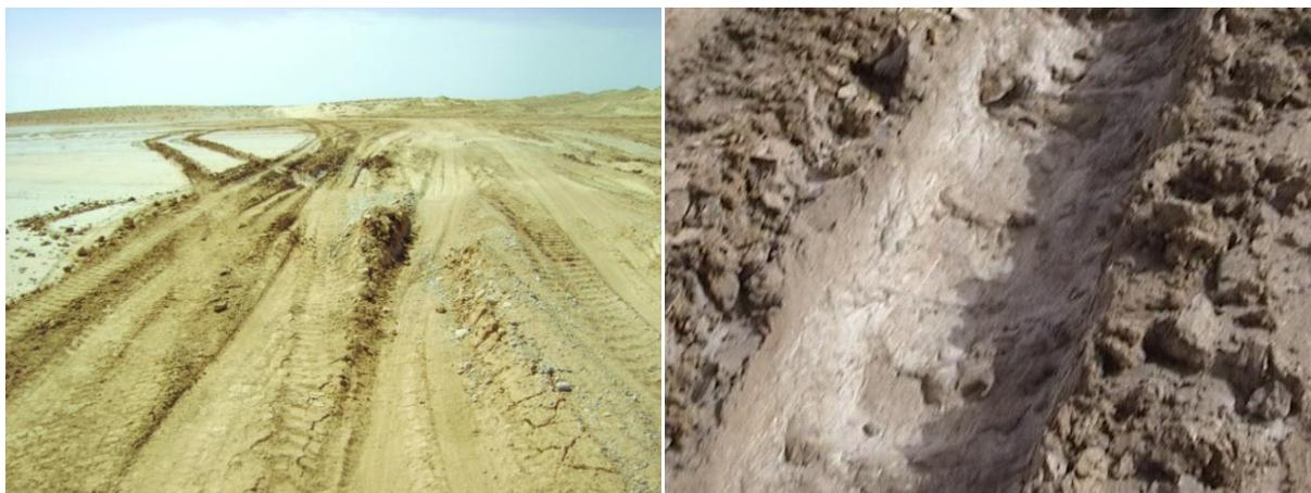
**Figure 4.6** Illustration de la réduction de la portance du sol de seabkha par une légère humidification
