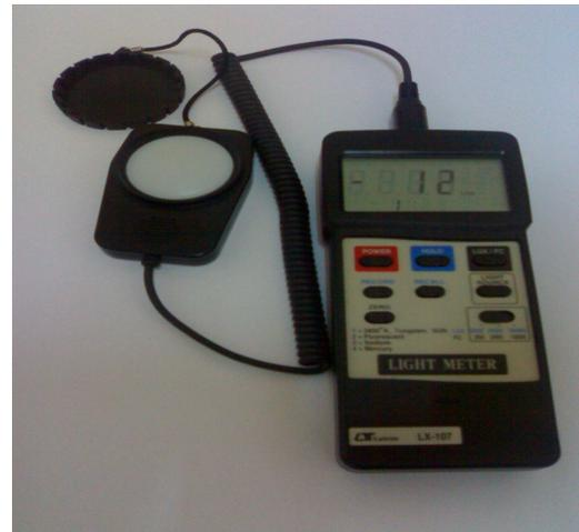
**Figure VIII.7: luxmètres pour les mesures extérieur. (Source: Auteur)**
