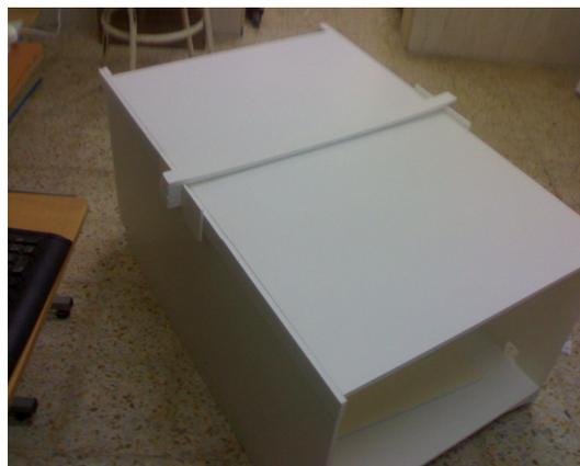
**Figure VIII.5: Raccordement des parois à l'aide de bande noire pour éviter toute pénétration parasite de lumière. (Source: Auteur)**
