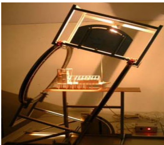
Figure B.12 : simulation de la lumière directe avec l'héliodon, Faculté D'architecture, Université de Hong-Kong (à gauche et à droite (Source: http://www.grap.ulaval.ca/Mission/CielArtificiel.html )
