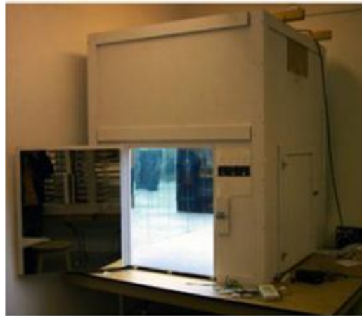
Figure B.13 : la boîte-miroir, le ciel artificiel, Université Laval (Source: http://www.grap.arc.ulaval.ca/Mission/CielArtificiel.html )
