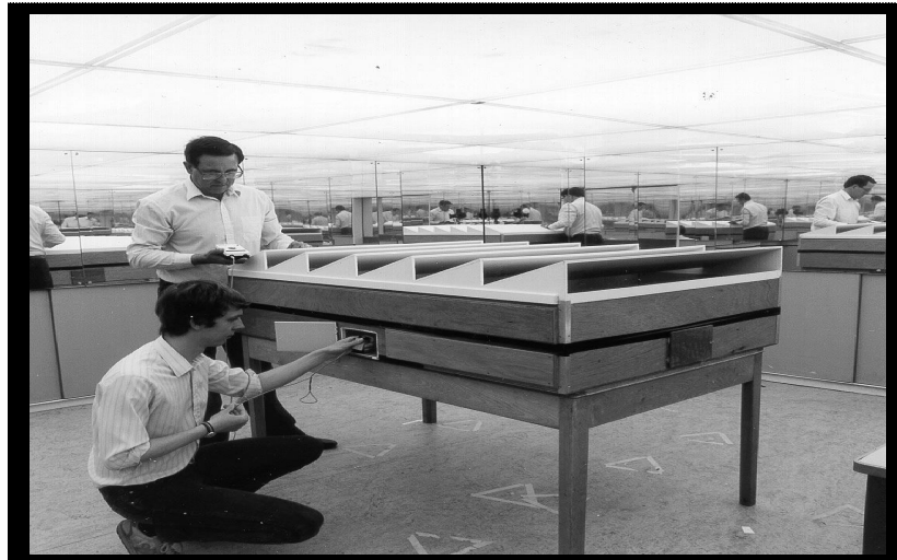
Figure B.11: Installation de la sonde photométrique dans le model réduit (Source : (IEA))
