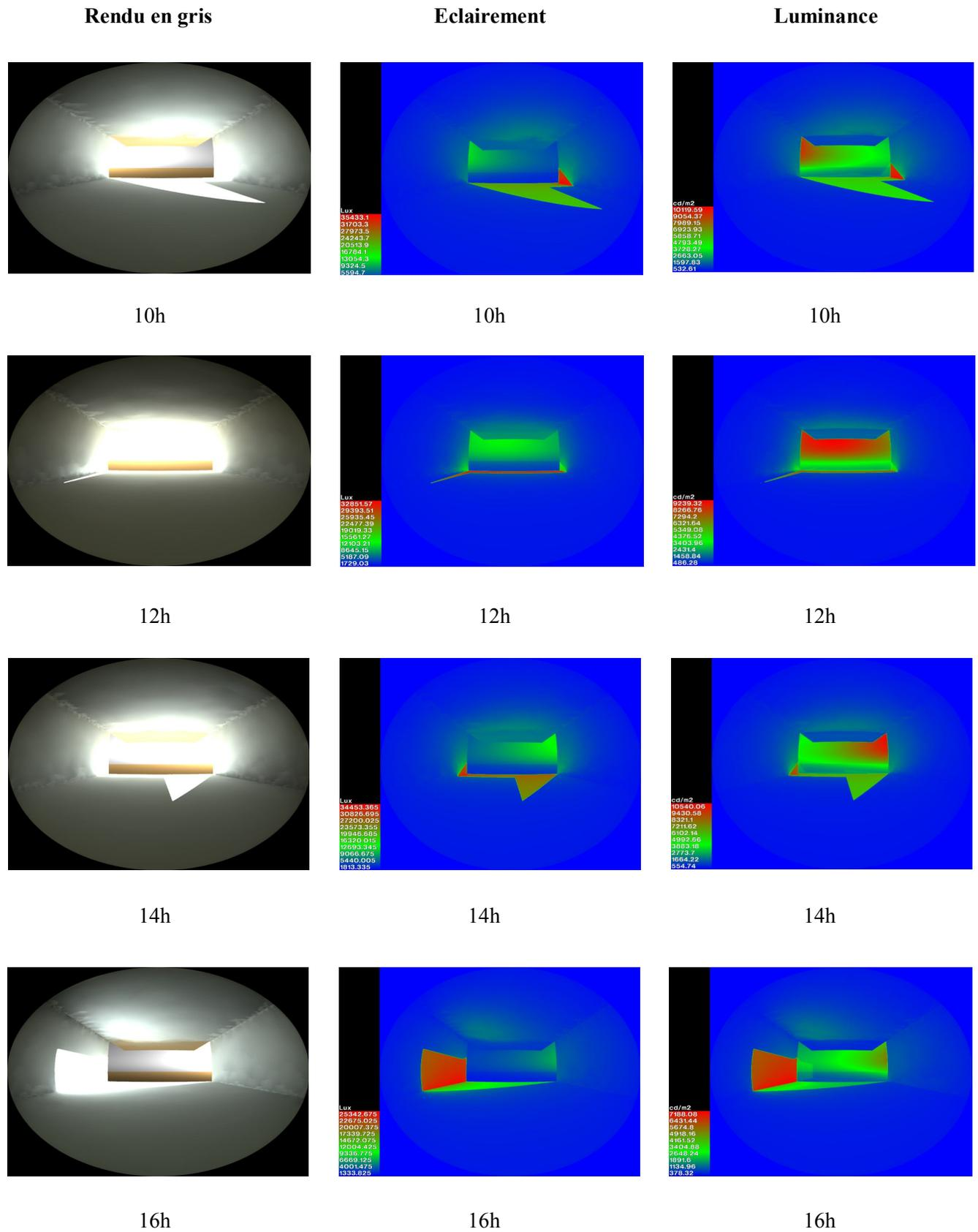
Figure F.1.1: Image Fish-eye simulé par « Radiance » des éclaircements et des luminances dans le Macro-champs visuel. Bureau Equipé d'un Auvent unique Orientation sud mois de Décembre
