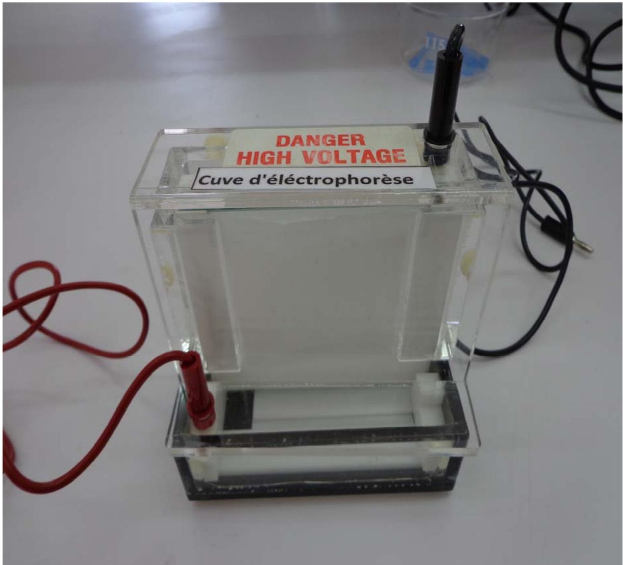
**Figure 19 : Mini-cuve d'électrophorèse OWL Thermo Fisher Scientific (dimensions des plaques 100 mm x110 mm) avec une plaque de refroidissement**
