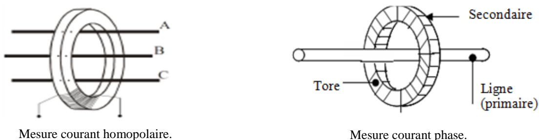
Figure. I.4. Transformateur de courant type tore.
