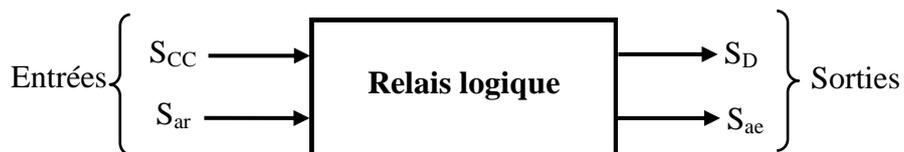
Figure IV.48. Schéma de principe d'un relais logique.
