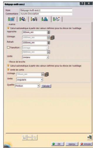
Figure 3.19d paramètres de la coupe
