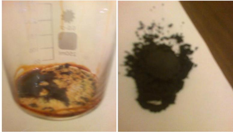
Fig.III.2 :  $\text{LSFN}_x$  en phase de sol et poudres après broyage
