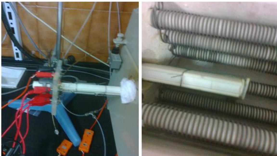
Fig.IV.4 : La cellule à l'extérieur et à l'intérieur du four
