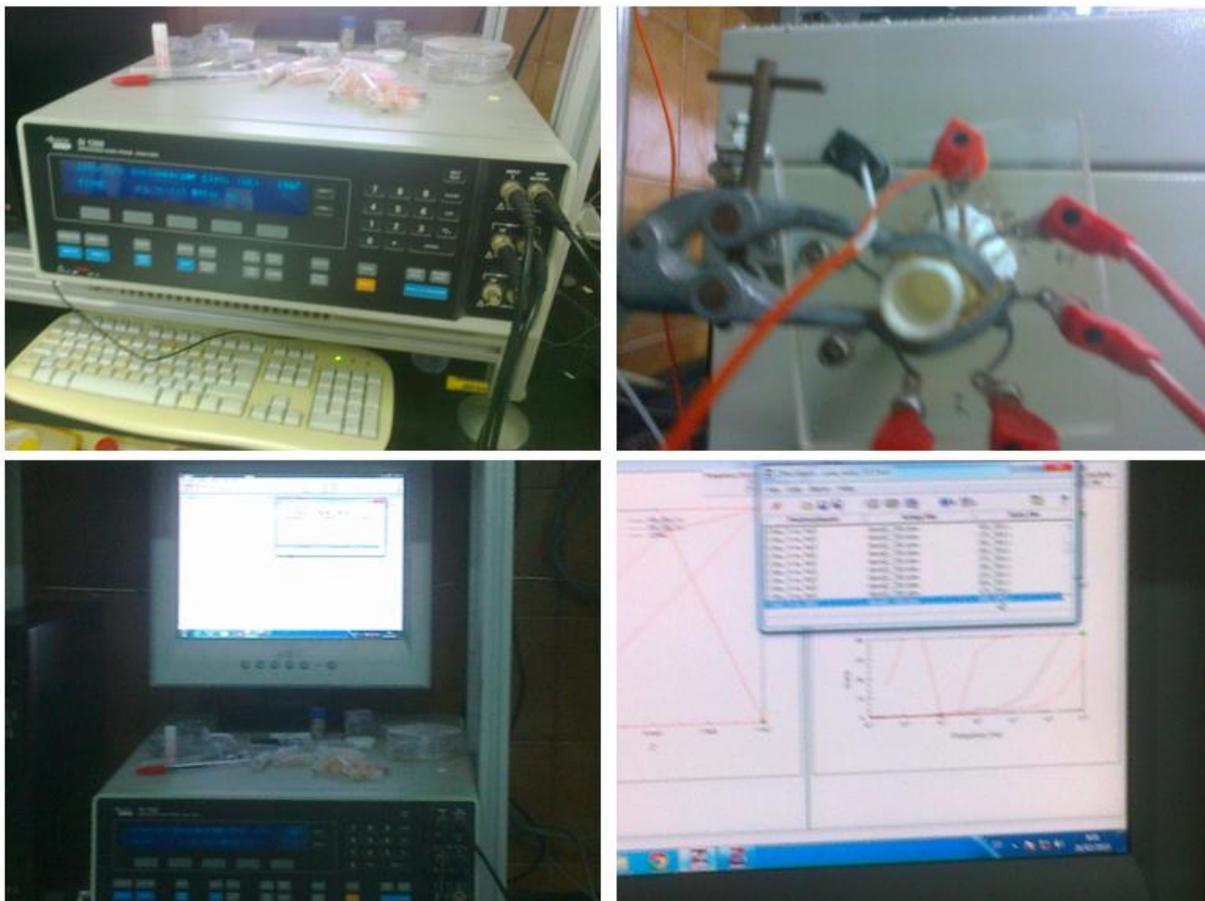
Fig.IV.3 : Dispositif expérimental, affiché sur l'ordinateur l'interface de Zplot.
