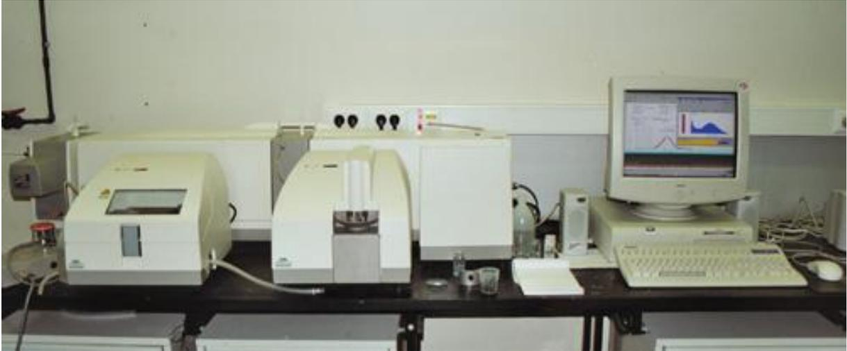
Fig.II.17 : Granulomètre Malvern Mastersizer 2000/3000
