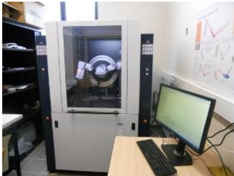
**Fig.II.6** : diffractomètre de type D8 Advance Bruker
