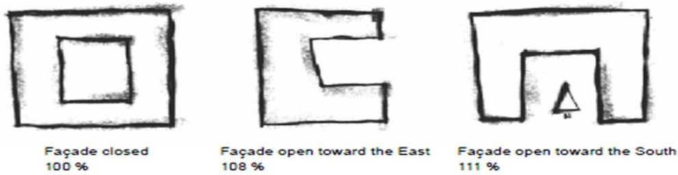
Fig.2.13 Analyse énergétique des formes de base de la construction
