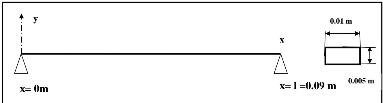
Figure III.14 Poutre appui simple - appui simple (Timoshenko)
