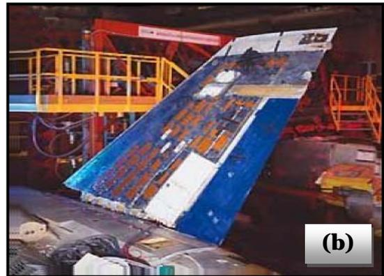
Figure I.8 Dispositif de contrôle actif de vibration d’une aile d’avion. (a) principe, (b) vue générale d’une aile équipée de transducteurs piézoélectriques.
