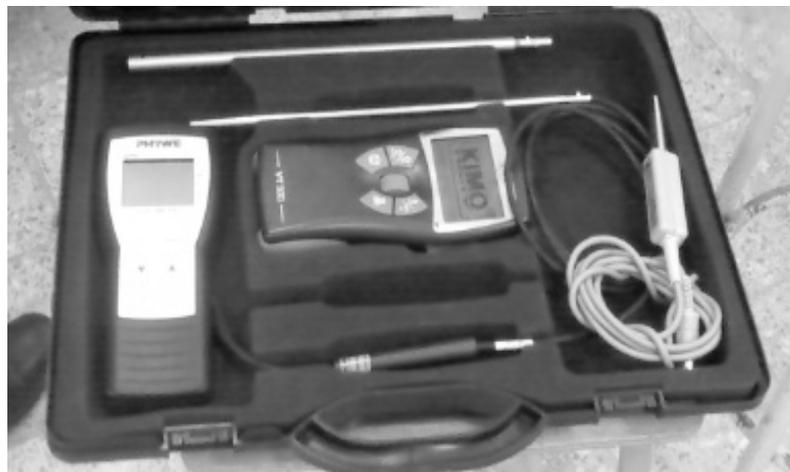
**Fig. 4.5.** Un anémomètre à fil chaud.
