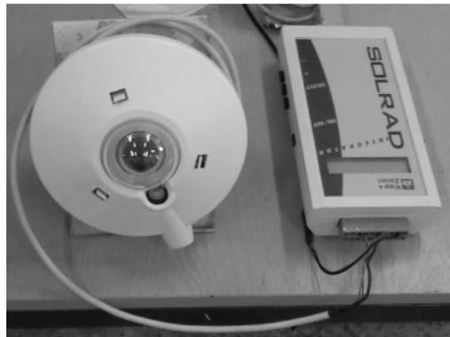
**Fig. 4.3.** Un solarimètre et un intégrateur de type Kipp et zonen.
