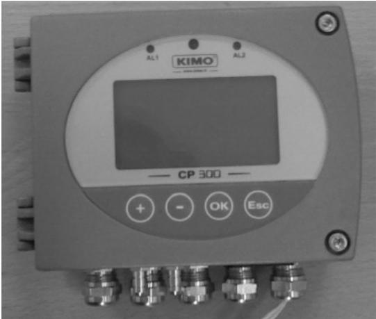
Fig.4.7. Manomètre différentiel digital.
