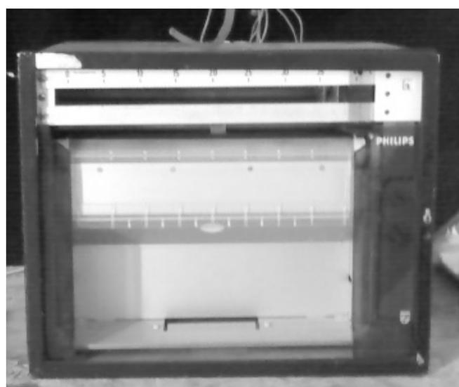
**Fig. 4.6.** Enregistreur de températures 12 voies.
