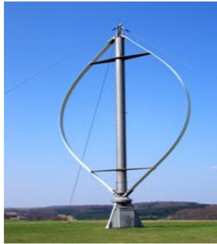
Figure I.3:Éolienne de type Darrieus.
