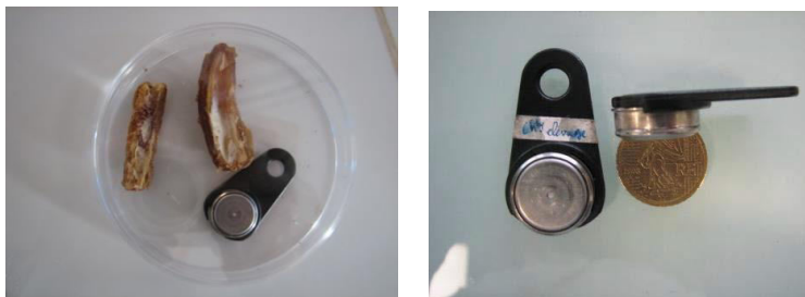
Figure 30 - Enregistreurs de la température et de l'humidité Captsystemes®
