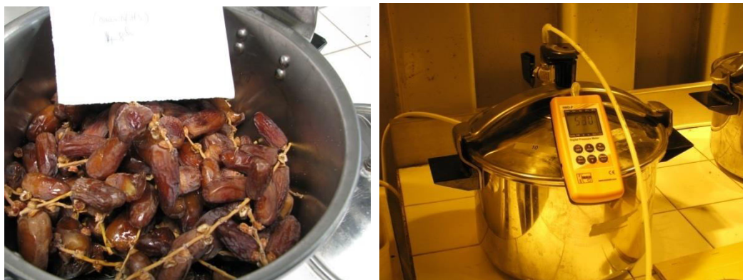
Figure 36 - Traitement des dattes à la phosphine pure gazeuse sous pression
