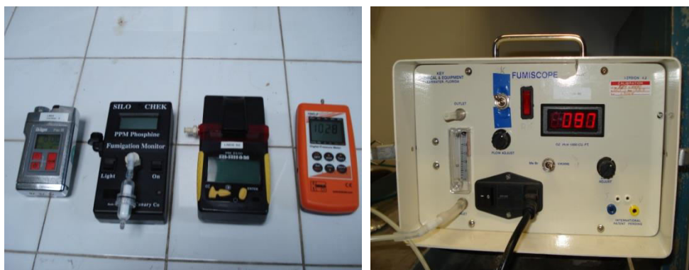
Figure 32 - Phosphinomètre à cellule électrochimique, Modèle MX2100 de Oldham
