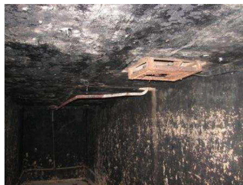
Figure 39 - Capteur (Captsystem®) de T°C et d'H.R. placé au centre du four
