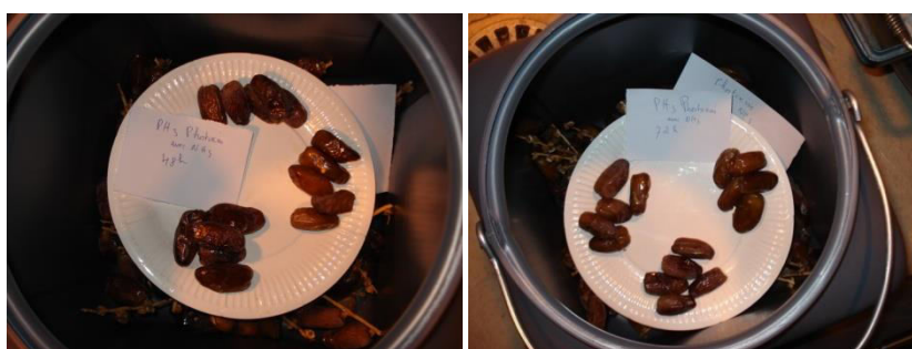
Figure 38 - traitement avec pilules de phostoxin, (enceinte 11 litres)
