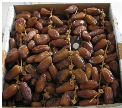
Figure 41 - Captsystem® pour mesurer la température à la surface des dattes
