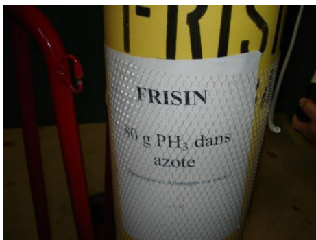
Figure 35 - Phosphine pure gazeuse sous pression dans l'azote
