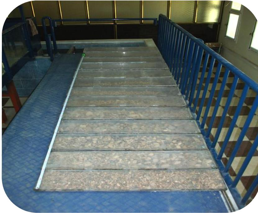
*Figure 1.8 : Photographie des marches positives testées*
