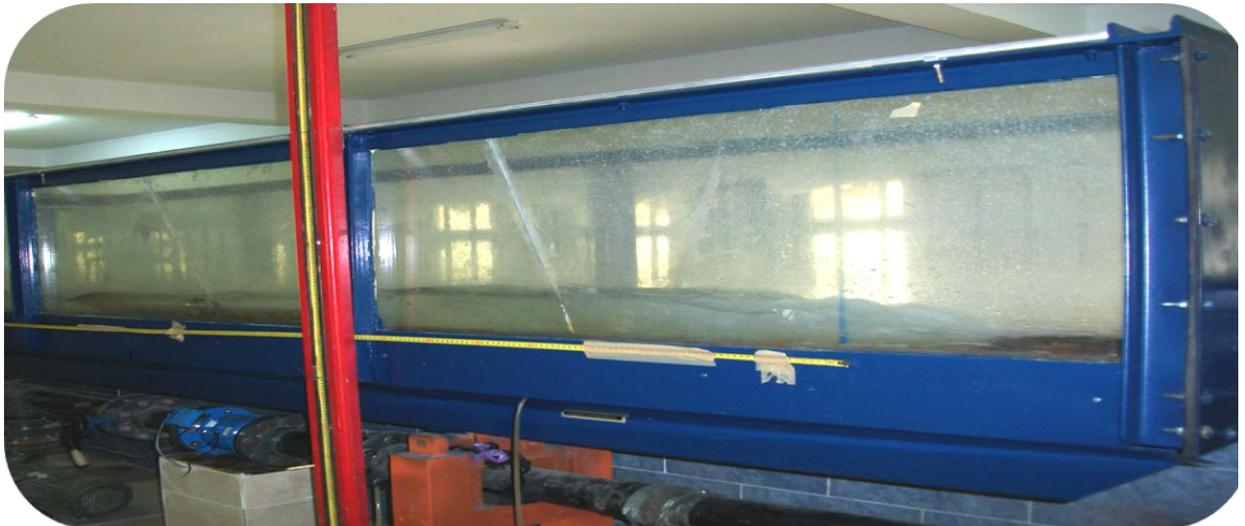
Figure 2.2: Photographie d'un ressaut hydraulique contrôlé par marche positive évoluant dans un canal trapézoïdal. Vue de profil
