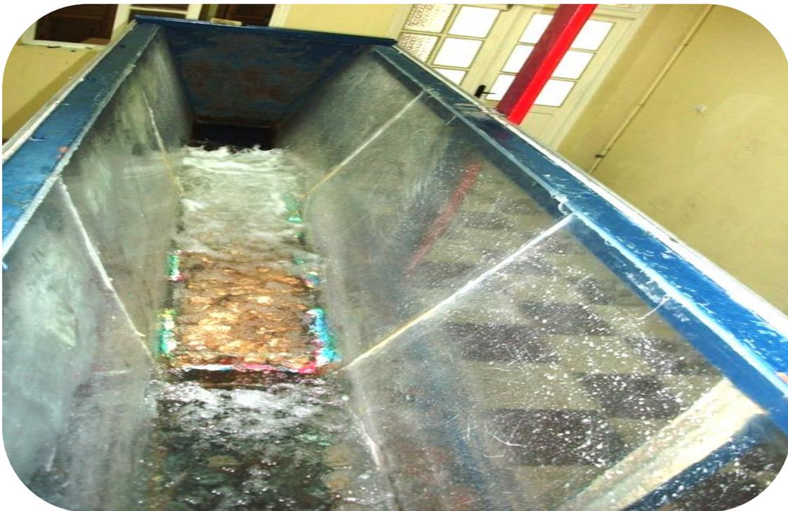
Figure 2.6: Photographie d'un ressaut hydraulique de type A, forcé par marche positive évoluant dans un canal trapézoïdal. Vue de face
