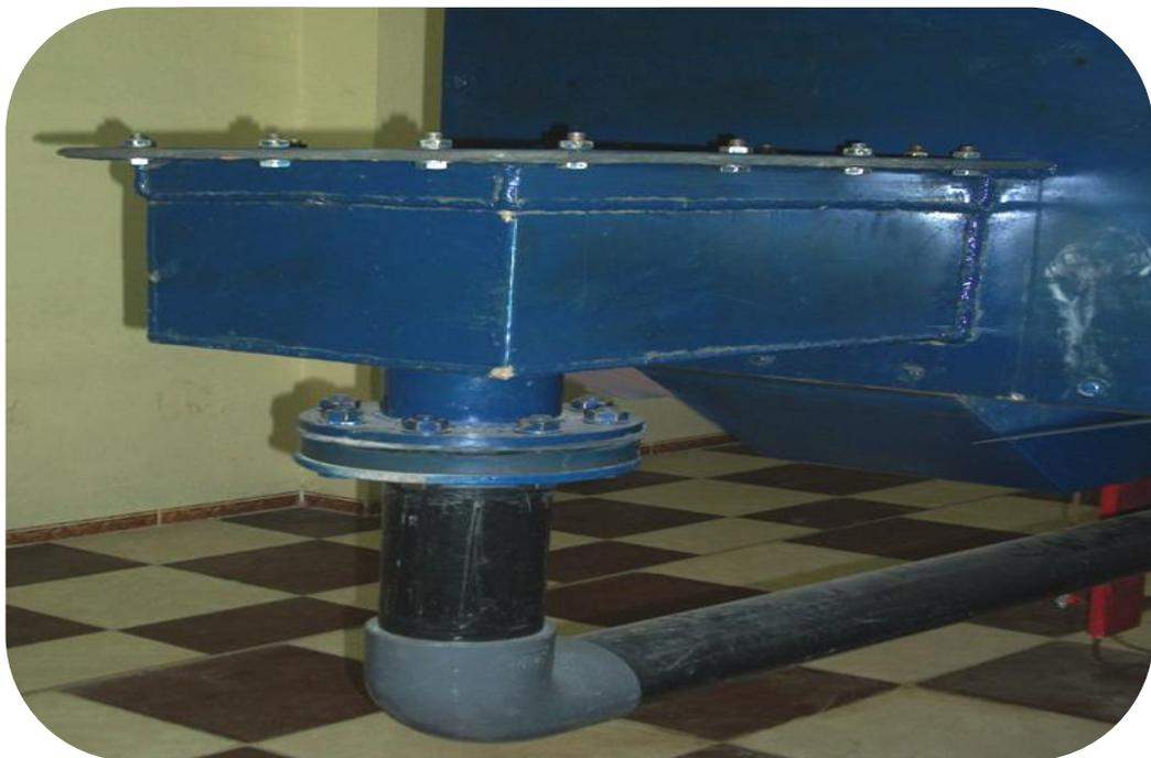
*Figure 1.5 : Photographie d'une boîte en charge*
