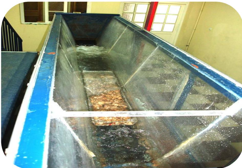
Figure 2.3: Photographie d'un ressaut hydraulique contrôlé par marche positive évoluant dans un canal trapézoïdal. Vue de face
