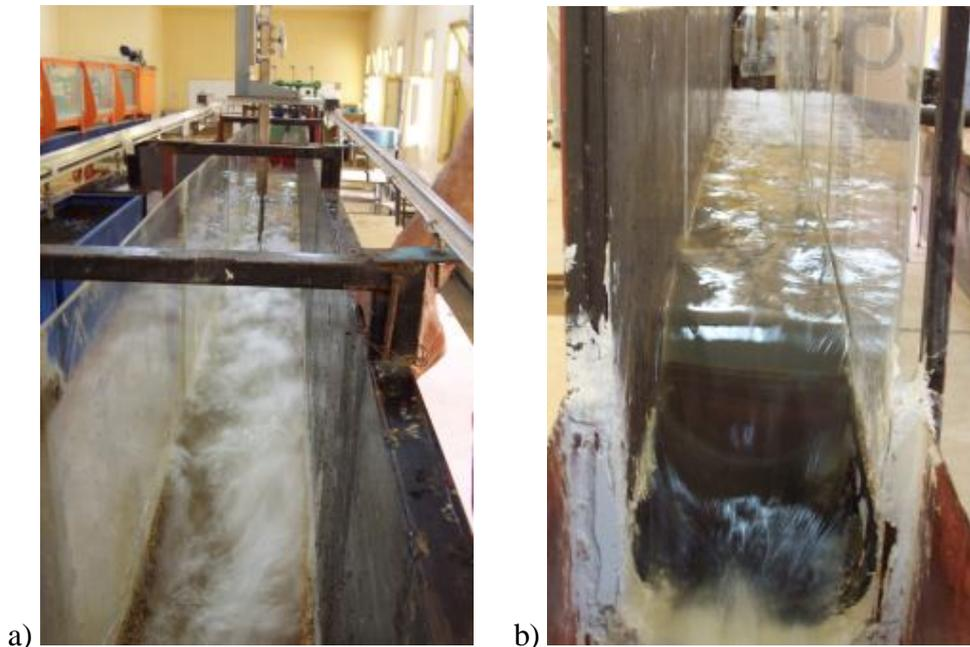
**Photo 5.9** : Ressaut hydraulique évoluant dans un canal profilé en "U" à fond rugueux.
