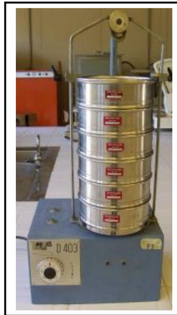
Photo 4.6: Série de tamis placés sur un vibreur.
