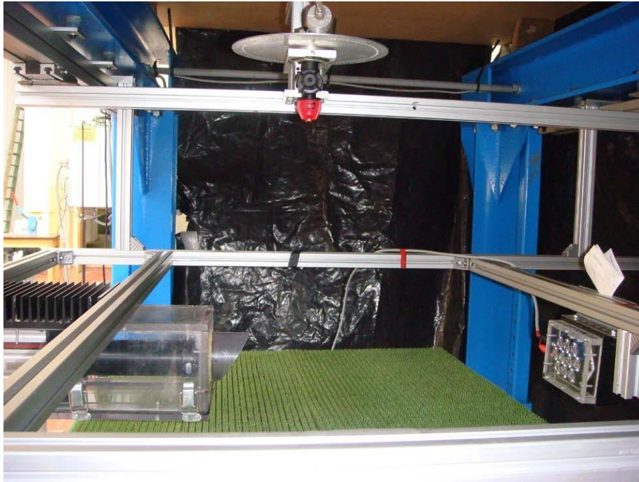
Figure 27 : Photographie du dispositif de mesure de granulométrie des buses de pulvérisation.
