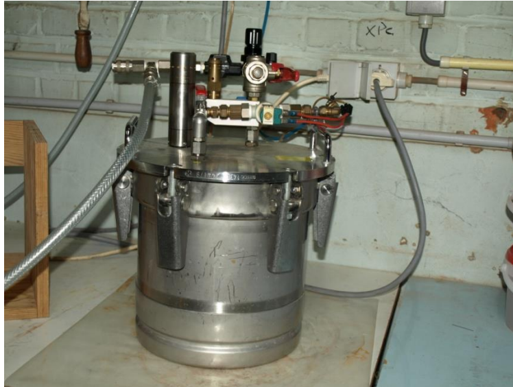
Figure 18: Photographie de la cuve sous pression alimentant la buse en bouillie
