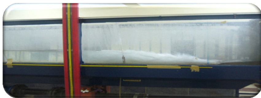
Photo 5.10 : Photographie d'un ressaut hydraulique contrôlé à pente positive F_1 = 8,96 ; s = 17\text{ cm} ; L_j = 164\text{ cm} ; h_2 = 20,8\text{ cm} ; \tan(\alpha) = 0,01
