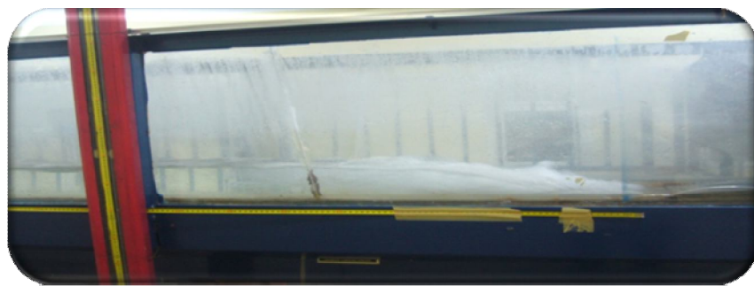
Photo 5.9 : Photographie d'un ressaut hydraulique contrôlé à pente nulle F_1 = 6,63 ; s = 7\text{ cm} ; L_j = 110\text{ cm} ; h_2 = 13,7\text{ cm} ; \tan(\alpha) = 0
