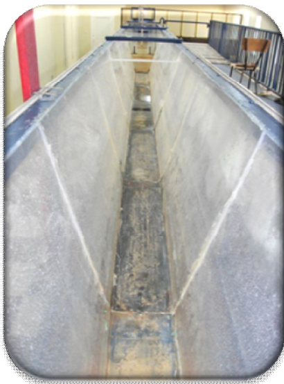
Figure 5.1 : Schéma simplifié du canal de mesure de section trapézoïdale, ayant servi à l'expérimentation.
