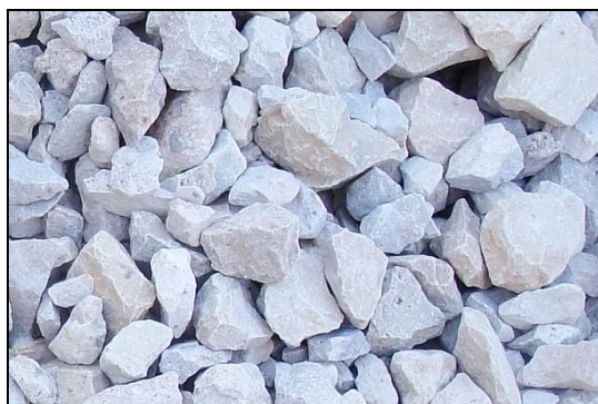
Photo 2.3 : Gravier de pierres concassées
