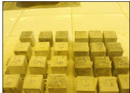
Photo 2.6 : Eprouvettes cubiques (10x10x10) cm 3 .
