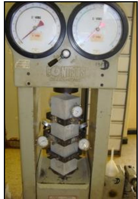
Photo 2.8 : Essai de déformabilité sur éprouvette prismatique (10×10×40) cm 3 .
