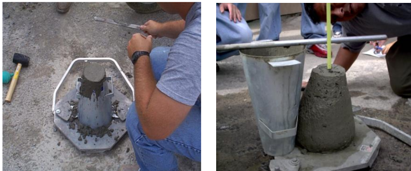
Photo 2.5 : Essai du Slump-test.
