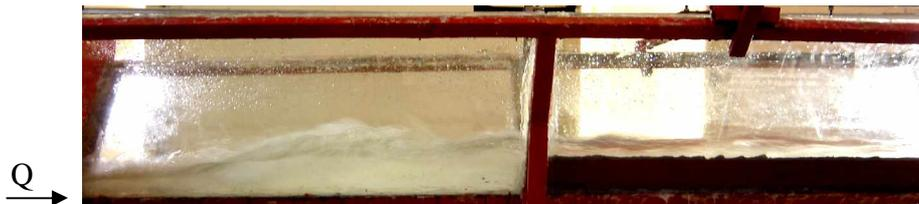
**Figure 7.3 :** Photographie d'un ressaut hydraulique contrôlé par marche positive.
