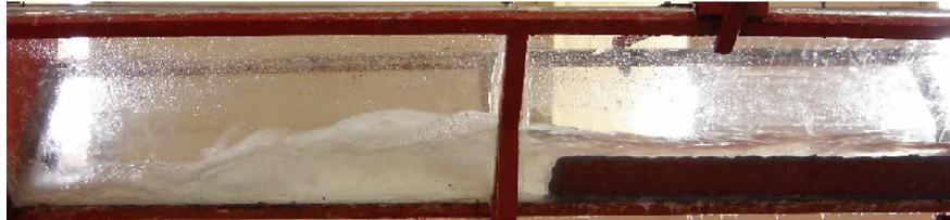
**Figure 7.7 :** Photographie d'un ressaut hydraulique de type A, forcé par marche positive.
