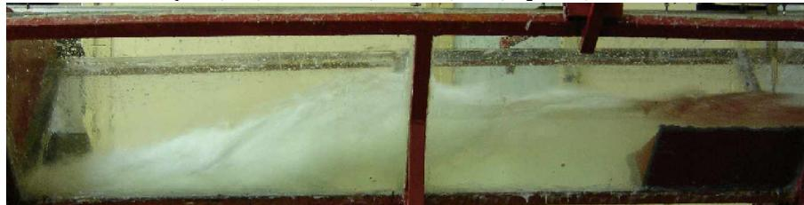
**Figure 7.9 :** Photographie d'un ressaut hydraulique de type A, forcé par marche positive.
