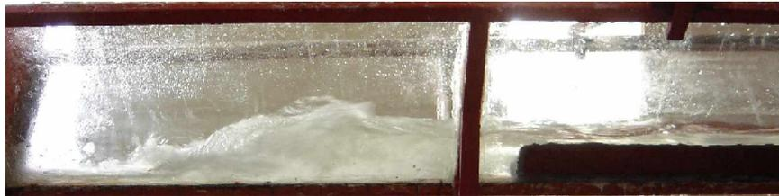
**Figure 7.8 :** Photographie d'un ressaut hydraulique de type A, forcé par marche positive.
