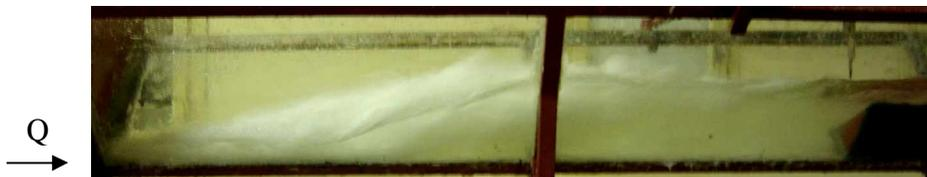
**Figure 7.5 :** Photographie d'un ressaut hydraulique contrôlé par marche positive.
