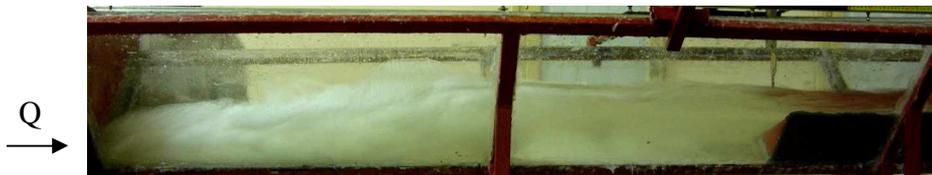
**Figure 7.4 :** Photographie d'un ressaut hydraulique contrôlé par marche positive.
