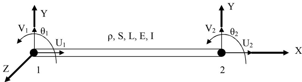
Figure3-3 : Élément poutre en flexion à six degrés de libertés
