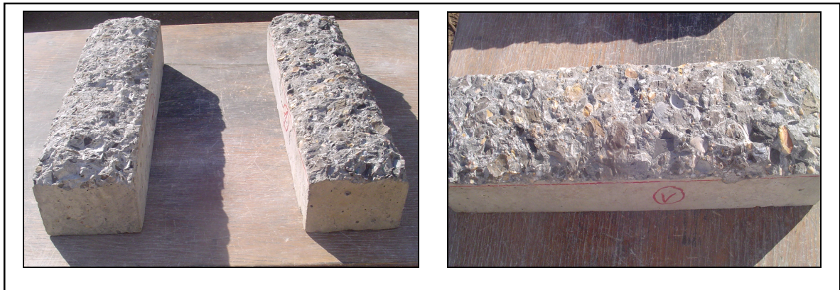
Photos 3.3 : Surfaces préparés après nettoyage
