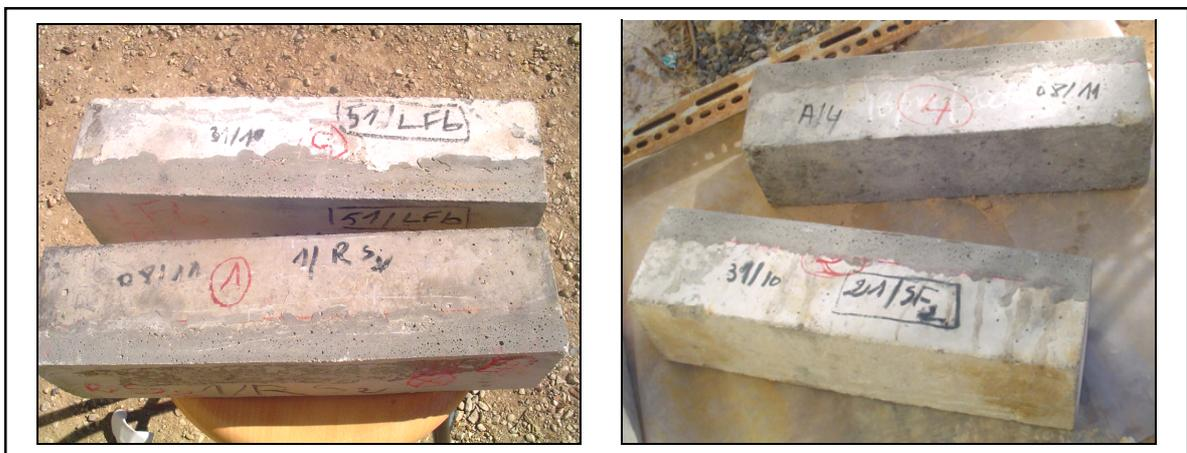
**Photo 4.3** : Etat des éprouvettes réparées après 4 mois
