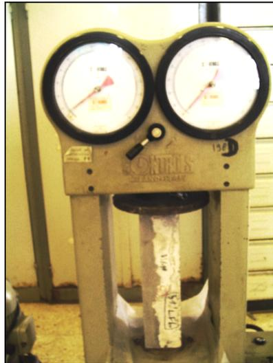
**Photo 4.4** : Position des éprouvettes réparées dans la presse
