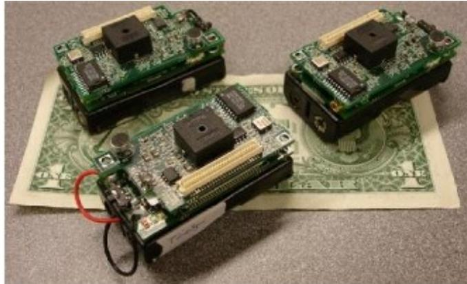
*Figure II. 1 Exemple de capteur intelligent MICA2 de Crossbow[39].*
