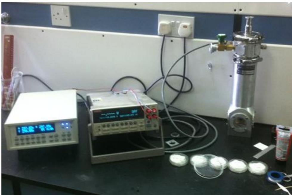
Figure II. 13: Système de mesure de la conductivité
