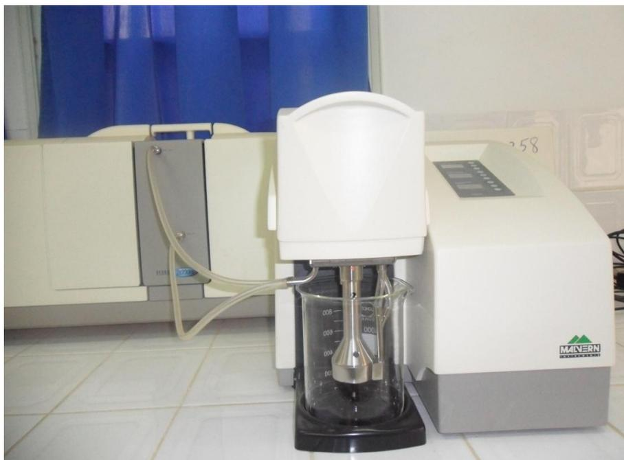
**Figure II. 9: granulomètre laser Malvern Mastersizer 2000/3000**
