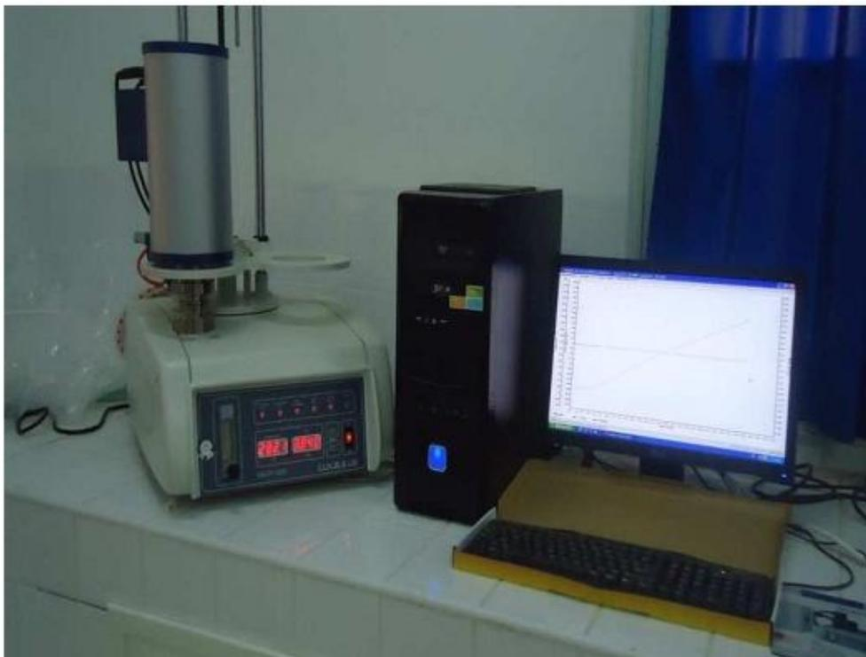
**Figure II. 3: Appareil Linseis STA PT1600**
